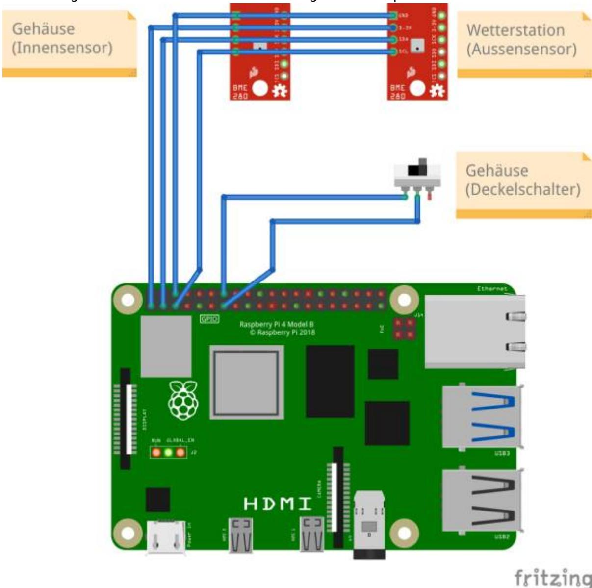
2. Derzeit können zwei I<sup>2</sup>C-Geräte konfiguriert werden. Da wir im Test zweimal einen BME208-Kombisensor für Temperatur, Luftdruck und Feuchtigkeit verwendet haben, haben wir den Konfigurationsbereich entsprechend aufgebaut:
