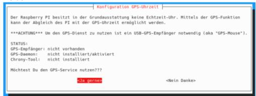
**Achtung:** Zeigt Setup an, dass kein GPS-Empfänger gefunden wurde an einer der USB-Ports, dann ist eine Installation zwar möglich, wird aber natürlich nicht funktionieren. Ob der GPS-Empfänger funktioniert oder nicht, kann man jederzeit im Menüpunkt STA erkennen. Wir haben gute Erfahrungen mit diesem GPS-Empfänger gemacht. Dieser kann sowohl GPS (USA) als auch GLONASS (Russische Föderation) empfangen und auswerten.
