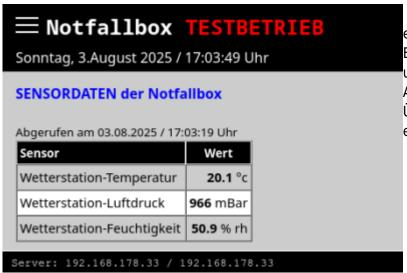
Was genau angezeigt wird, darüber entscheidet der Systemverwalter. Beispielsweise kann er die über GPIO, I<sup>2</sup>C und SPI einkommenden Daten auf die Ausgabe einer Wetterstation oder die Überwachung der Stromversorgung einschränken.
