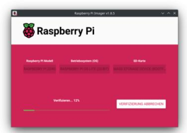
6. Nach dem Ende die Speicherkarte / den USB-Stick vom Programmiercomputer entfernen (wurde automatisch ausgeworfen) und in den PI einsetzen.
