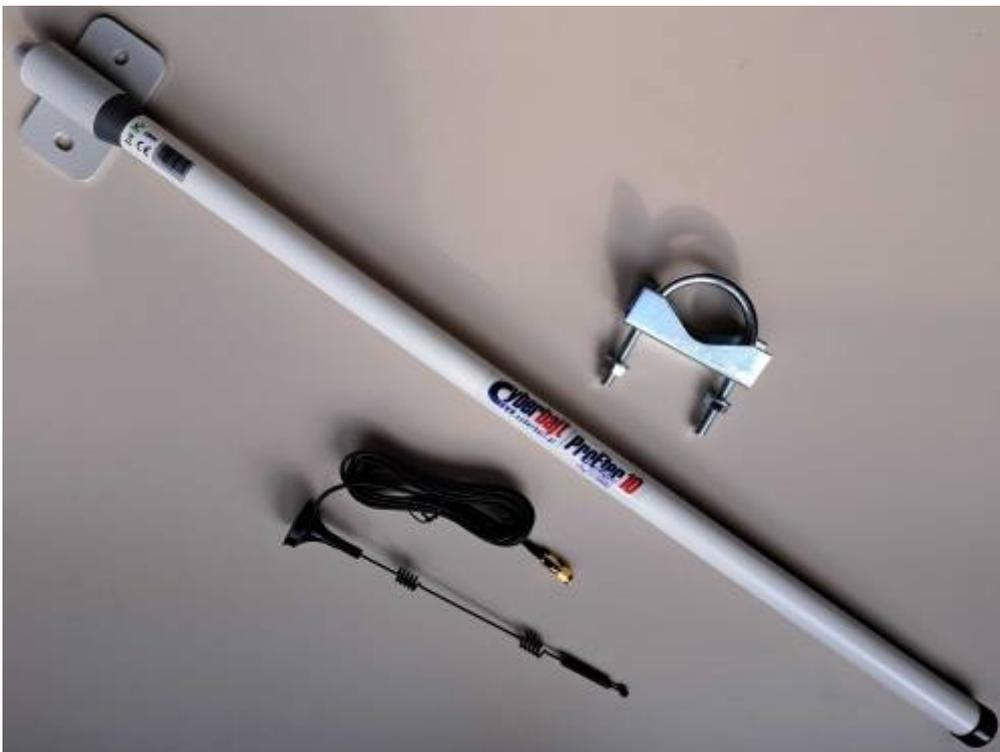
Damit wir den Dongle auch effektiv nutzen können, benötigen wir eine ordentliche Außenantenne! Diese gibt es in zigfachen Ausführungen im gut sortierten Fachhandel bereits mit Masthalterung für unter 30 €. Wichtig ist natürlich auch das Antennenkabel - gerade weil wir im WLAN-Bereich mit 2,4 GHz arbeiten. Das Thema wird hier noch ausführlich dokumentiert.
