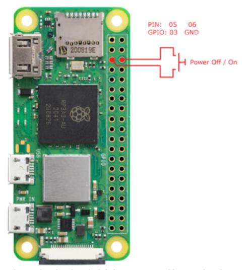
An den Pins 05 (GPIO03) und 06 (GND) wird ein Taster angeschlossen. Die Belegung ist bei ALLEN Pl-Modellen gleich.
