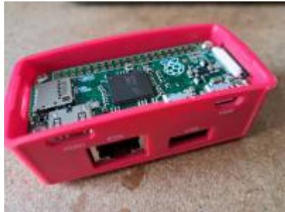
4. WLAN-Dongle in freien USB-Port stecken. Zum Aufbau und Test zuhause reicht die beim Dongle mitgelieferte Antenne völlig aus.
